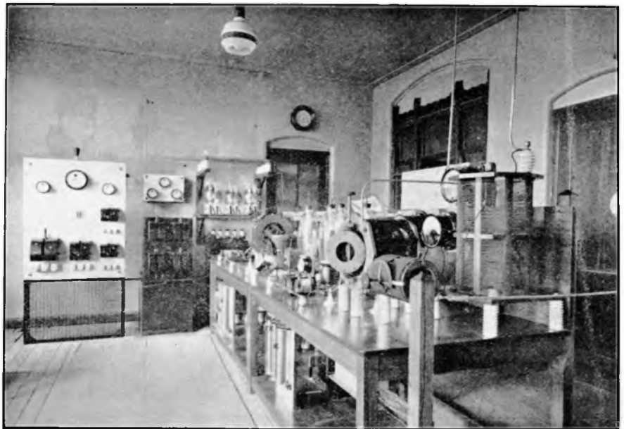
6 K. W. telefoniezender in gebruik van den zakelijken omroep.
